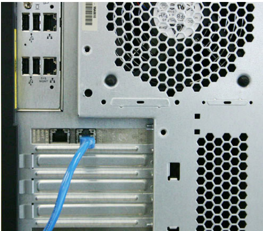
Figura 7. Vista da porta Ethernet 0
