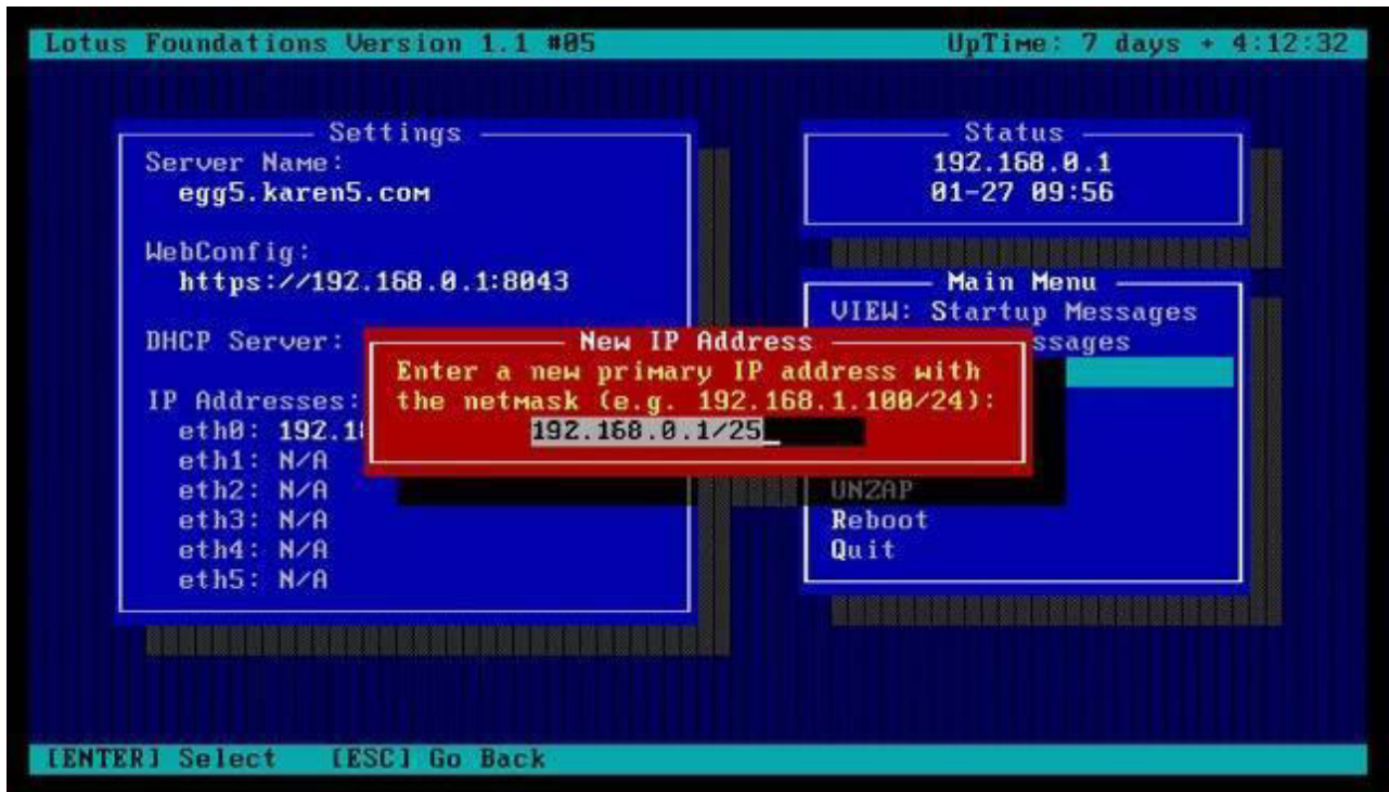
Figura 9. Configurando o Endereço IP a partir do Console do Servidor Lotus Foundations
